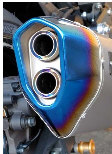
新型サイレンサー出口
